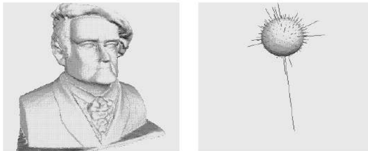
FIG. 3.9 – Exemple de répartition des normales sur la sphère unité Chaque vecteur correspond au centre d'une région. Sa direction correspond à celle de la normale définie au centre de la région. Sa longueur représente la somme des tailles des faces dont la normale appartient à cette région (figure prise de [12]).
